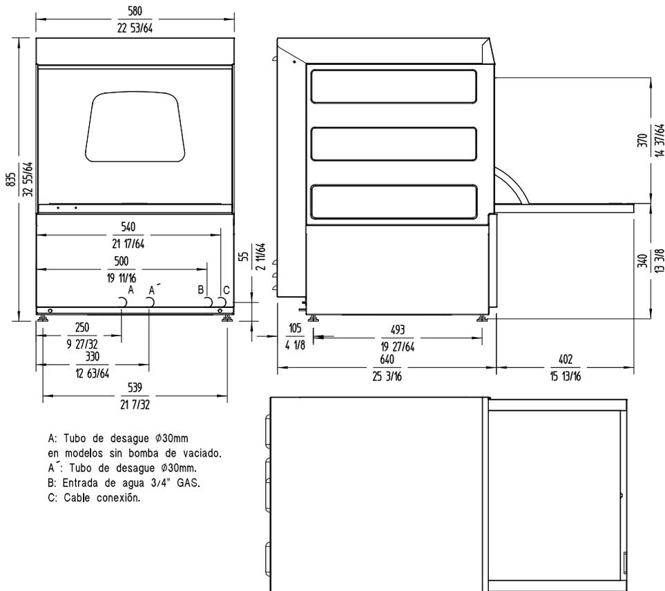
A: Tubo de desague Ø30mm en modelos sin bomba de vaciado.
